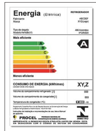
Figura 22: Exemplo de etiqueta de eficiência energética Nivel A para refrigerador do Programa Brasileiro de Etiquetagem (Inmetro)
