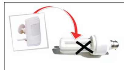
Figura 8: Sensor de presença sem uso de lâmpada fluorescente
